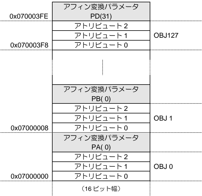
図 6-20 OAM メモリマップ（2D グラフィックスエンジン B はアドレスに+0x400）
