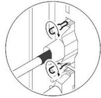
**手順 4** 本体部後面の DC コネクタに AC アダプターの DC プラグを接続します。続いて、AC アダプターの AC プラグをコンセント (AC 100V) に接続します。
