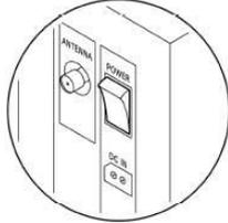
**手順 2** 本体部後面のアンテナコネクタにアンテナを取り付けます。アンテナネジを締めてアンテナを立ててください。
