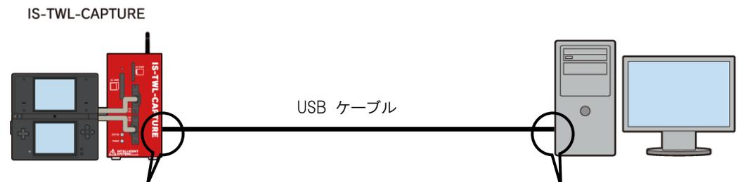
本体部後面の USB コネクタに USB ケーブルの B コネクタを接続します。
