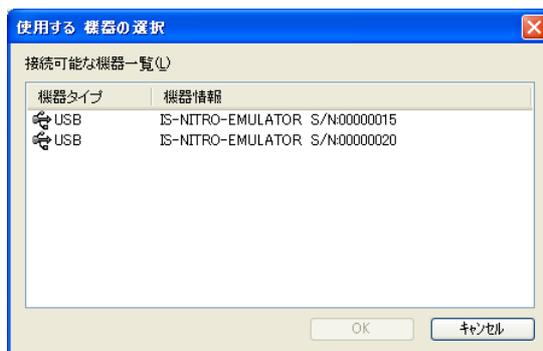
このダイアログには、IS-NITRO-EMULATOR のシリアル番号がリストアップされます。(シリアル番号は IS-NITRO-EMULATOR 底面のシールに記載されています。)ここで、使用する IS-NITRO-EMULATOR を選択し [OK] ボタンをクリックすることにより、選択した IS-NITRO-EMULATOR で IS-NITRO-DEBUGGER を起動することができます。
